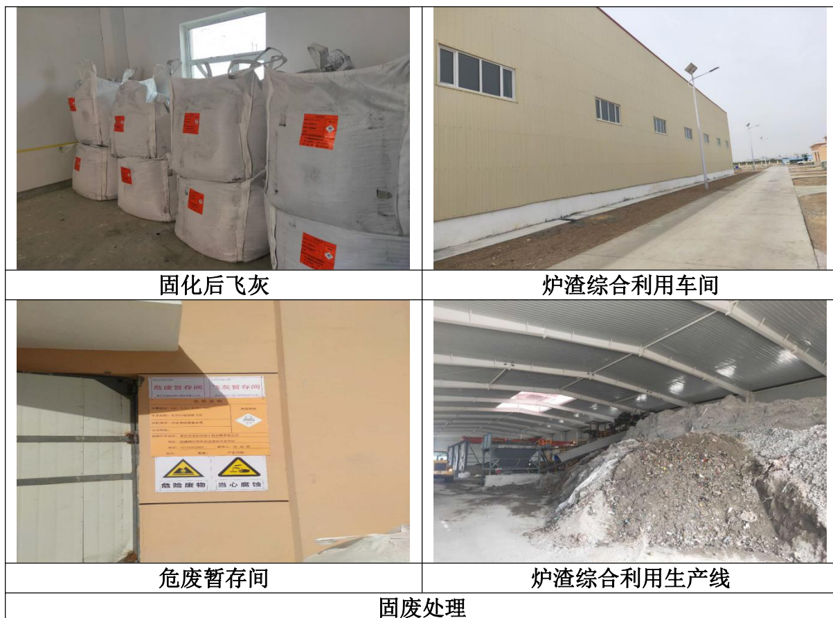
图 4-6 固废现场照片
